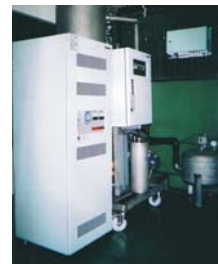
テコネッツシャワー （オーダーメイド商品） オゾンガス発生量 100g/h オゾン水量 20l/h オゾン水濃度 4ppm
