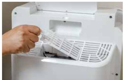
止めフックを指で押さえながら上へ引き上げてカバーを取り外します。
