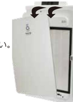
フロントカバーの取付方法は、本体下部の爪孔にカバー下部の爪を差し込んで取り外しとは逆の手順で取り付けてください。
