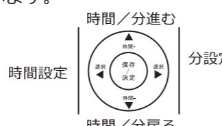
時間が点滅している間に、リモコンで発生時間を設定してください。
